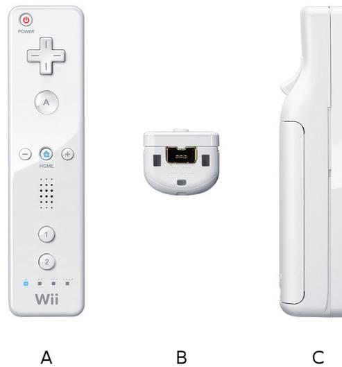
Abbildung 2.3: Positionen zur Kalibrierung des Wiimote
